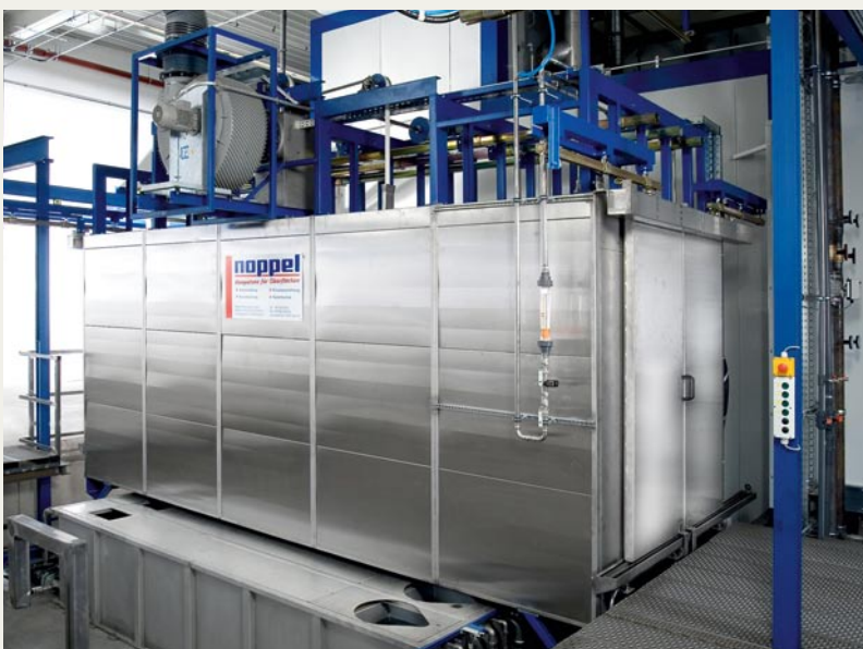
▲ Verschiebbarer Sprühtunnel bei dem Lohnbeschichter Kopp. Bei dem Dienstleister bewährt sich die Quertaktvorbehandlung seit vier Jahren.
