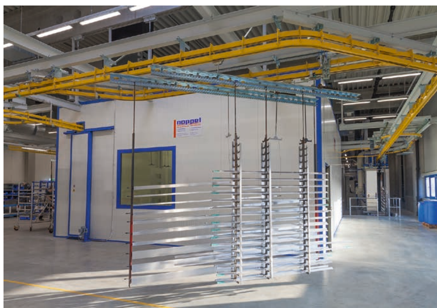
Auf einer Fläche von 1000 Quadratmetern entstand die neue Pulverbeschichtungsanlage. Sie ist für Werkstücke aus Aluminium ausgelegt.
