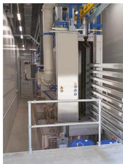
Vor der Pulverbeschichtung erfolgt die nasschemische Vorbehandlung und chromfreie Passivierung der Werkstückoberflächen in einer 4-Kammeranlage.
