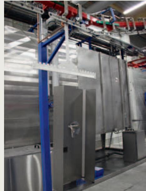
Ein Sensor erkennt das jeweilige Werkstück und gibt ein Signal zur Auswahl der passenden Vorbehandlung
