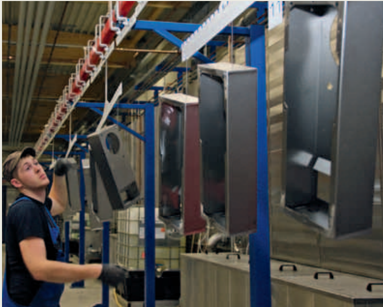
Das Anlagenkonzept ermöglicht es dem Betreiber, unterschiedliche Substrate wie Stahl, verzinkten Stahl oder Aluminium nach sehr hohen Qualitätsstandards zu beschichten
