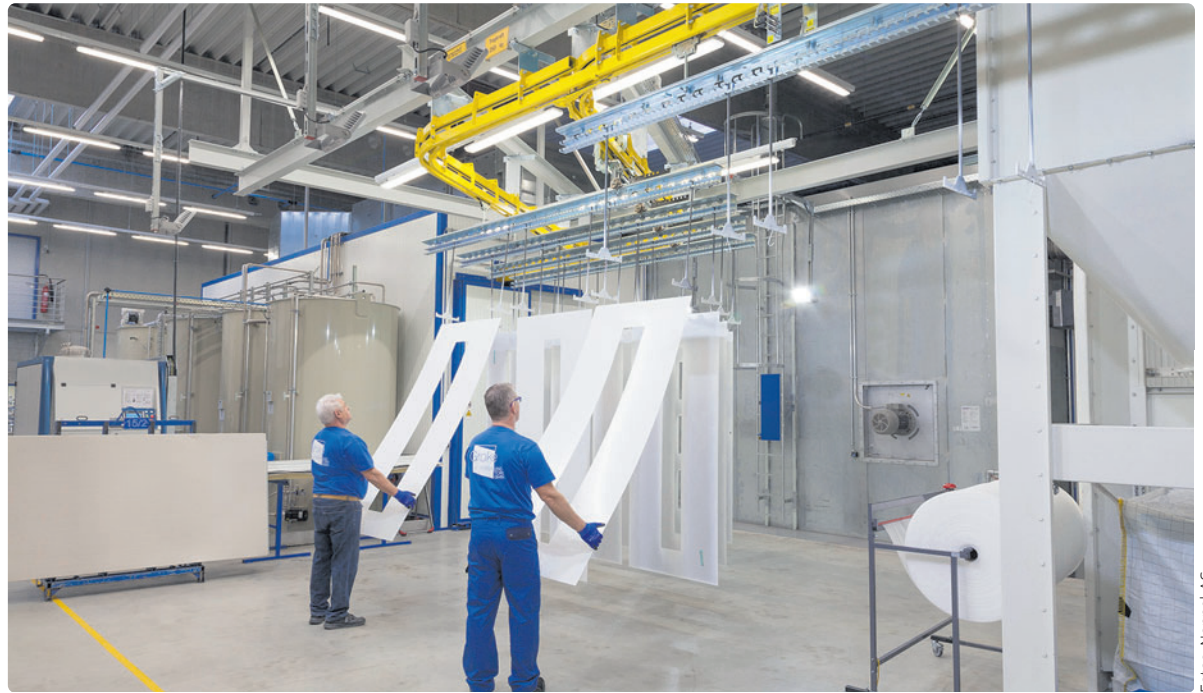
Manuelle Endkontrolle am Ende der Pulverbeschichtungsanlage
